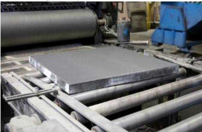
**Bildunterschrift:** Nach der Demontage werden die Bodenplatten in den Lindner Werken auf Vorschädigungen geprüft und aufbereitet.
